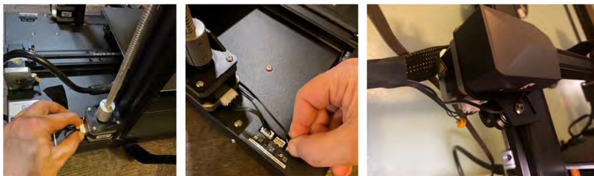
Рисунок 3.6 – Підключення кабелів
