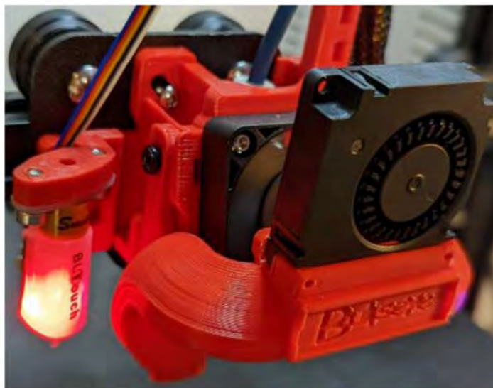
Рисунок 2.4 – Приклад фізичної модернізації охолодження
