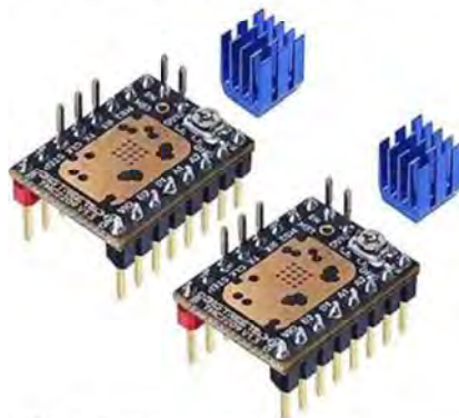
Рисунок 3.2 – Драйвери крокових двигунів TMC2209
