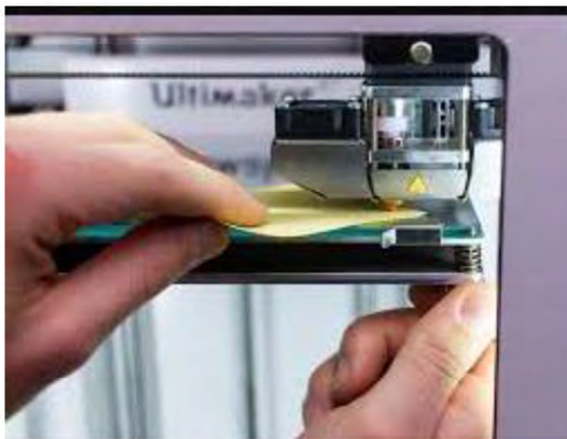
Рисунок 3.8 – Калібровка осі Z
