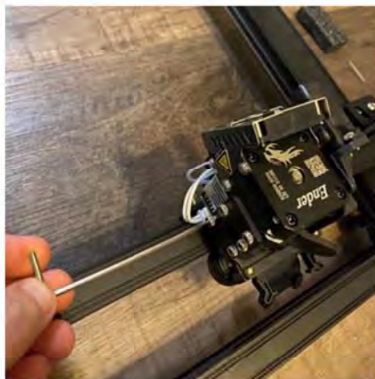
Рисунок 3.5 – Встановлення екструдера
