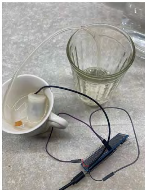
Рисунок 3.15 – Реалізація підключення крапельного поливу
