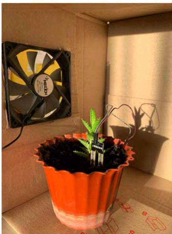
Рисунок 3.9 – Розміщення датчика вологості ґрунту
