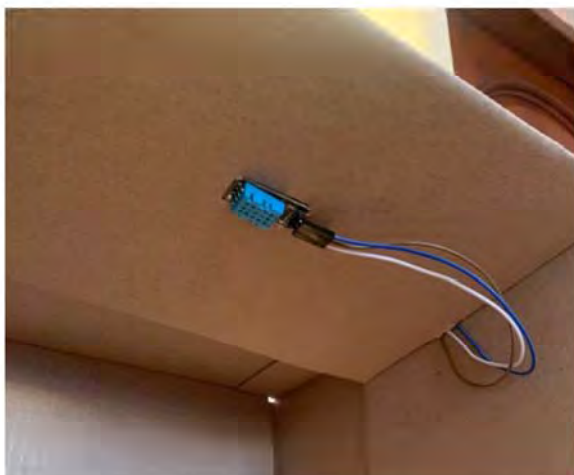
Рисунок 3.8 – Розміщення датчика температури та вологості
