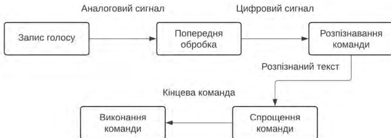
Рисунок 2.8 – Діаграма потоків даних в системі
