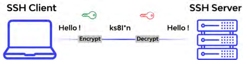
Рисунок 2.2 – Передача даних за допомогою SSH-протоколу
