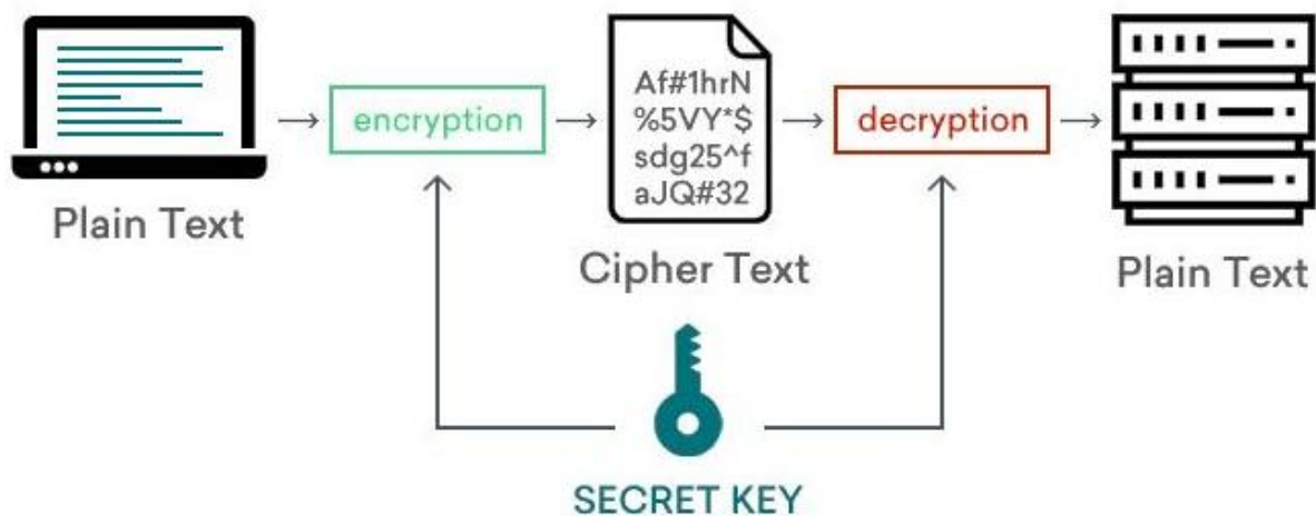
Рисунок 1.3 - Принцип роботи симетричного шифрування
