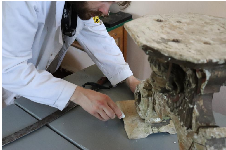
Рис. 7. Процес заміру вологовмісту деревини фрагменту основи скульптури у Шумському краєзнавчому музеї
