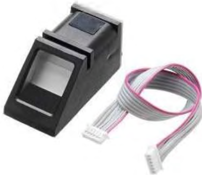
Рисунок 3.2 – Біометричний датчик відбитків пальців DY50_MAIN_V3
