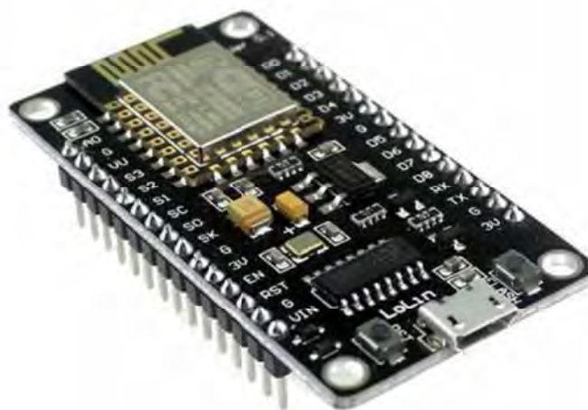
Рисунок 3.1 – Плата мікроконтролера ESP8266 LoLin
