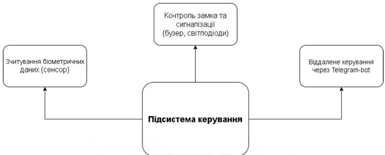
Рисунок 2.1 – Структурна схема системи
