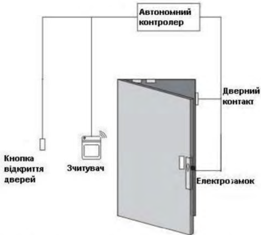
Рисунок 1.1 – Типова структура роботи системи керування дверним замком
