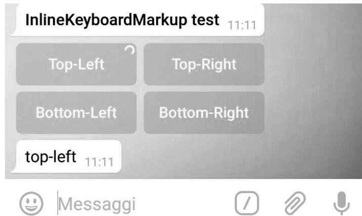
Рисунок 3.10 – Приклад клавіатури InlineKeyboardMarkup.
