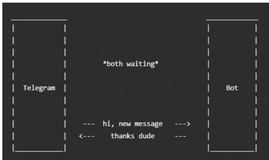
Рисунок 2.5. – Схема роботи webhook ботів.
