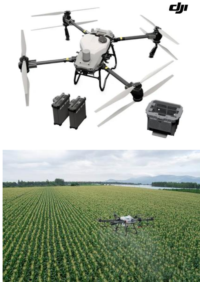
Рисунок 2.5 – Аграрний безпілотний літальний апарат – дрон DJI AGRAS T50
