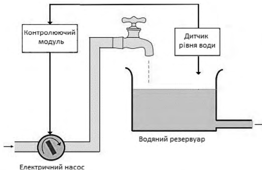
Рисунок 1.1 – Типова структура системи контролю рівня води
