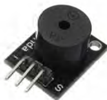
Рисунок 3.5 – Модуль бузера
