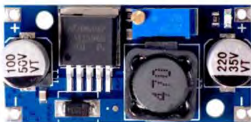
Рисунок 3.6 – Понижуючий стабілізатор живлення LM2596
