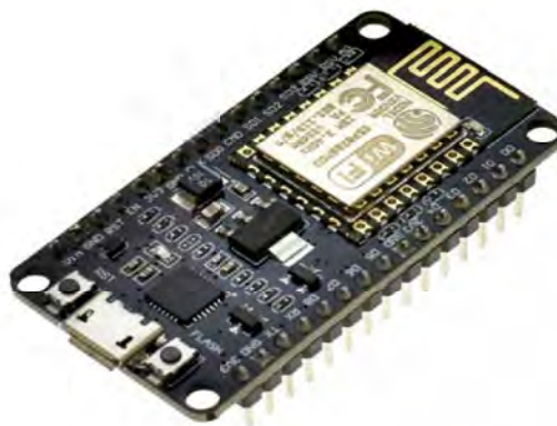
Рисунок 3.1 – Мікроконтролер ESP8266 на платі розробки NodeMCU
