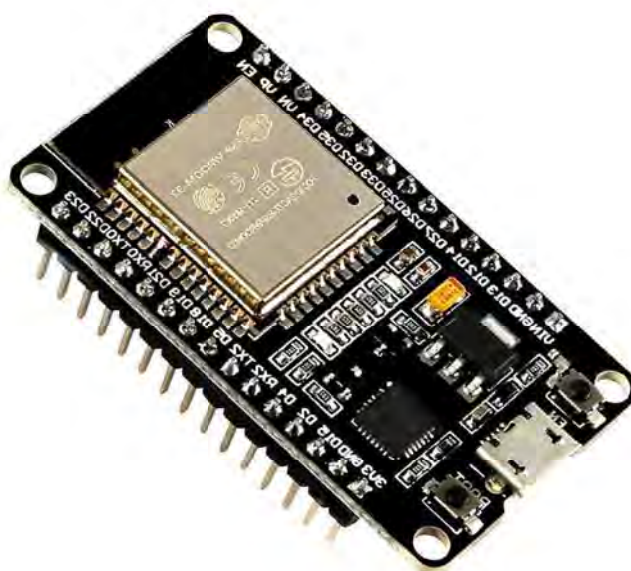
Рисунок 3.1 – Зовнішній вигляд контролера ESP32
