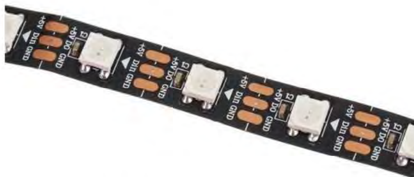
Рисунок 3.3 – Зовнішній вигляд стрічки WS2812b
