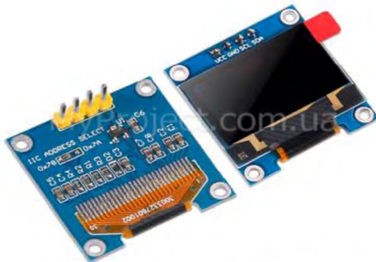
Рисунок 3.2 – Зовнішній вигляд OLED екрану SSD1306
