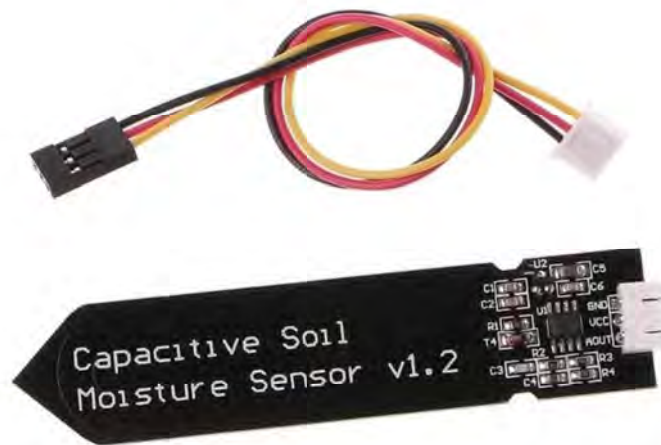
Рисунок 2.6 – Датчик вологості Moisture Sensor v1.2
