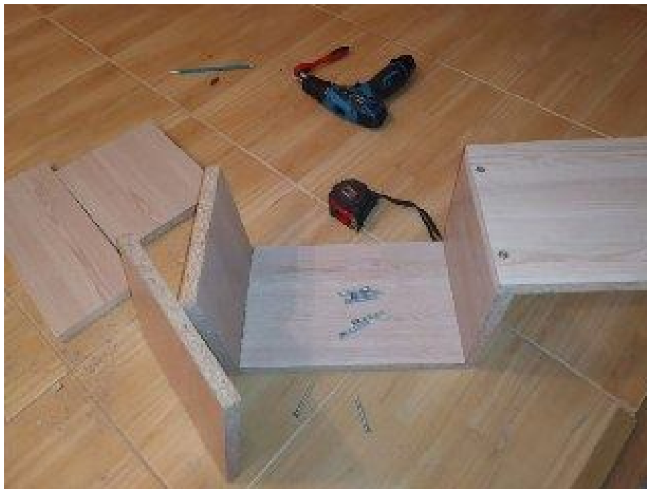
Рисунок Д.5 – Скручування полиць
