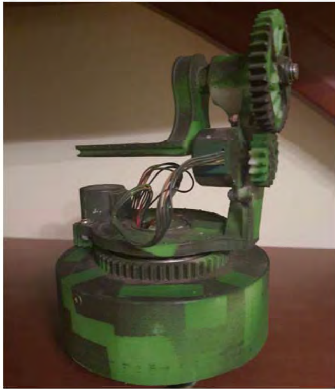
Рисунок 3.7 – Готова модель механічної структури штативу
