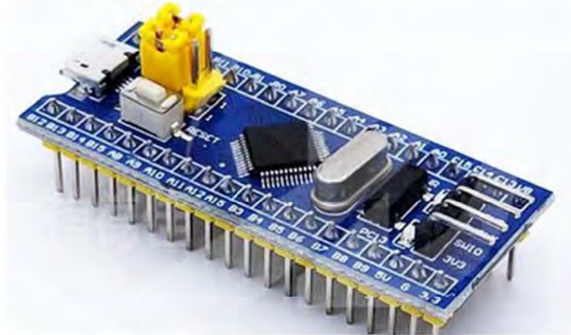
Рисунок 3.2 – Мікроконтролер STM32F103C8T6
