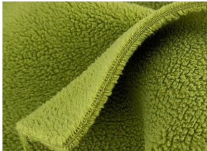
Рис. 1. Будова ворсового начісного трикотажного матеріалу типу «фліс»
