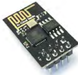
Рисунок 2.3 – Wi-Fi модуль ESP8266
