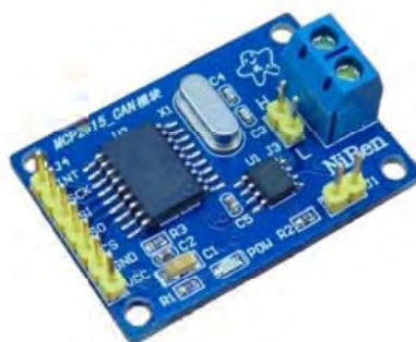
Рисунок 2.2 Модуль CAN шини на MCP2515
