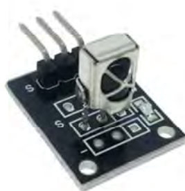
Рисунок 3.3 – ІЧ-модуль KY-022
