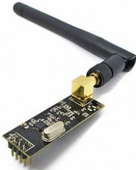
Рисунок 4 – NRF24L01+PA+LNA з зовнішньою антеною
