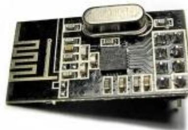
Рисунок 3 – nRF24L01 з вбудованою антенною NRF24L01+PA+LNA.
