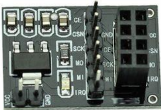
Рисунок 5 – Адаптер для модулів nRF24L01 та NRF24L01+PA+LNA
