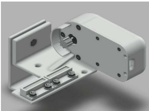
Рис. 1. 3D-модель корпусу для монтажу крокового двигуна та герконів
