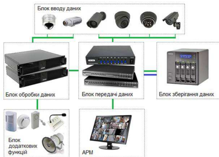
Рисунок 2- Схема автоматизованої системи охоронного відеомоніторингу
