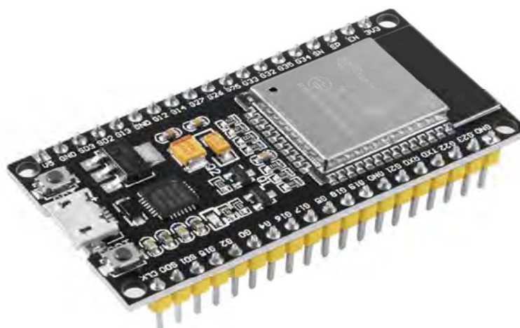
Рисунок 3.1 – Мікроконтролер ESP32 з WiFi-модулем
