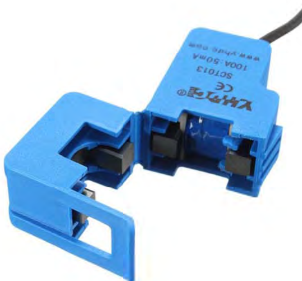
Рисунок 3.3 – Датчик SCT-013-000
