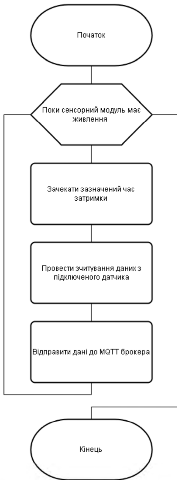
Рисунок 3 – Блок-схема алгоритму взаємодії сенсорних модулів та MQTT брокера
