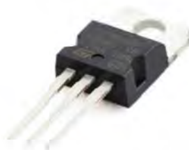
Рисунок 3.5 – Стабілізатор напруги 5В LM7805 в корпусі TO-220
