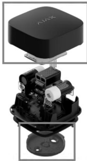
Рисунок 1.6 – Корпус та панель для кріплення
