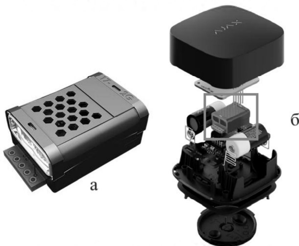
Рисунок 1.3 – Сенсор Sunrise-006-0-0008-NDIR (а – зовнішній вигляд, б – його розміщення в системі)
