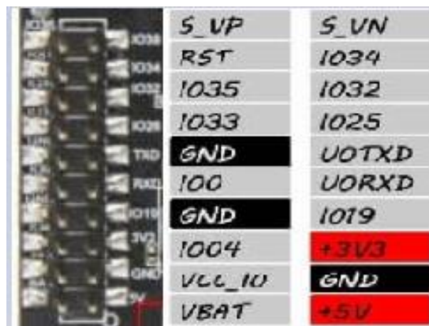
Рисунок 2.10 – Схема виводів TTGO
