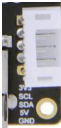
Рисунок 3.8 – Виходи для підключення ІЧ-камери
