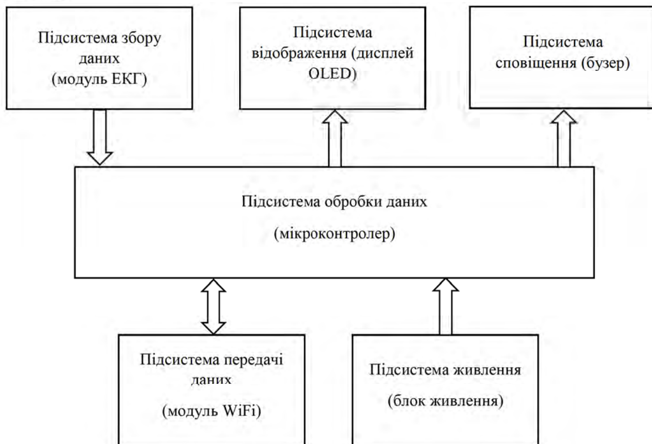
Рисунок 2.1 – Структурна схема апаратної частини системи
